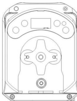
**Fig. 21- Retiro del tubo peristáltico**
